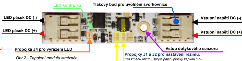
Obr. 2 - Zapojení modulu stmívače
