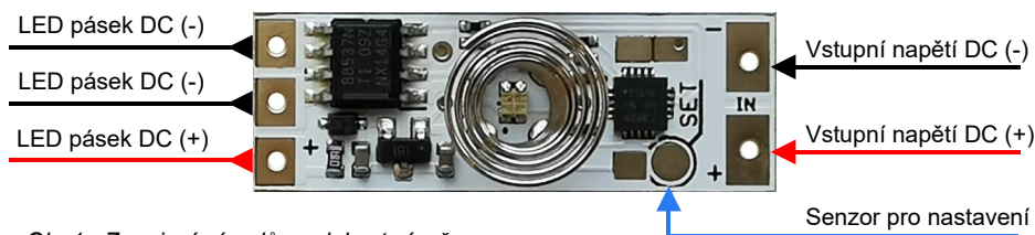
Obr.1 - Zapojení vývodů modulu stmívače
