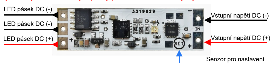
Obr.1 - Zapojení vývodů modulu stmívače
